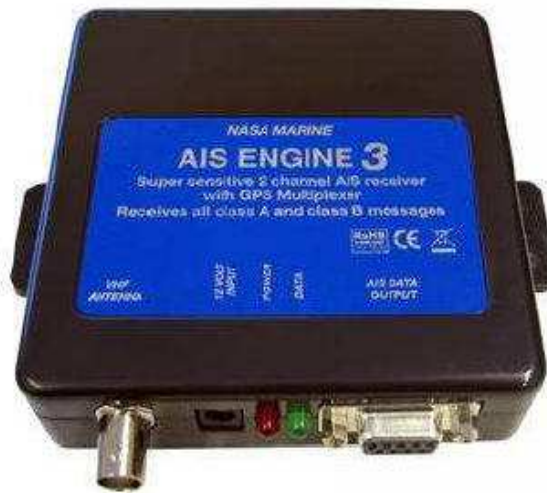
Il mio primo rx per l'A.I.S. ,della Nasa Marine, questo rx necessita di collegamento al computer.
