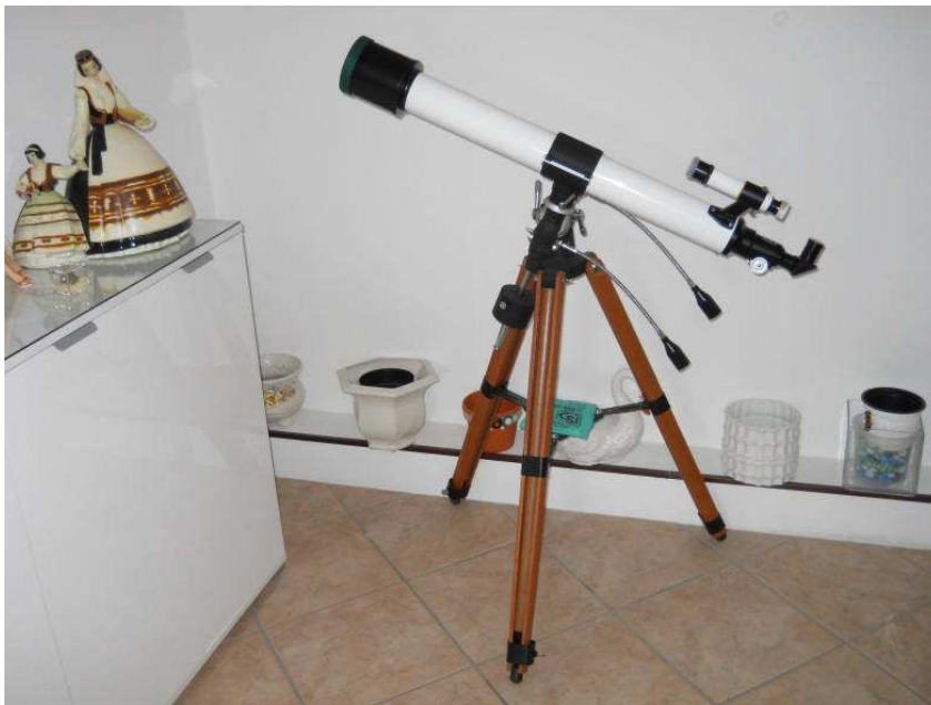
Telescopio SkyMaster dotato di doppietto acromatico ben corretto e adatto per l'osservazione dei pianeti - Proprietà dell'Autore.
