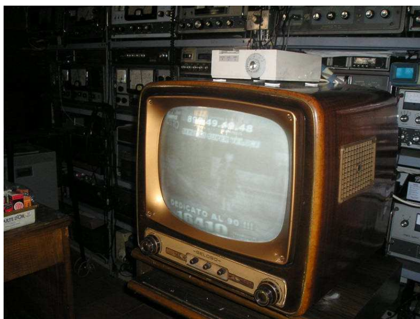
GTV. 1005 restaurato con sopra il convertitore aggiunto per il secondo programma
