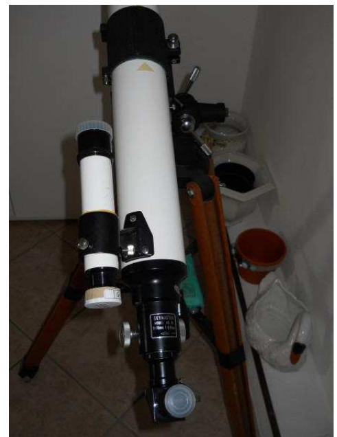
Telescopio SkyMaster dotato di doppietto acromatico ben corretto e adatto per l'osservazione dei pianeti - Proprietà dell'Autore.
