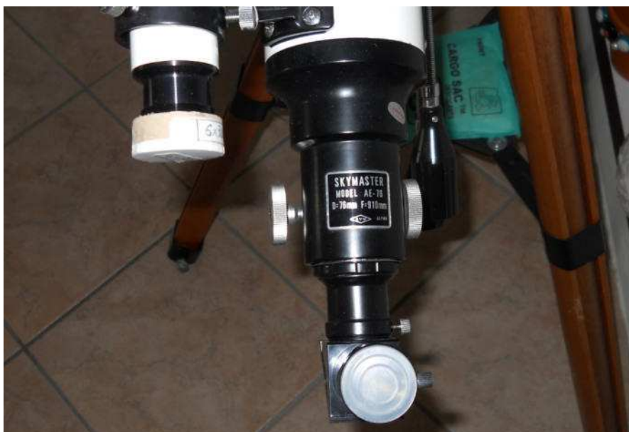
Telescopio rifrattore, montatura Equatoriale tipo Fraunhofer "SkyMaster" 76/910 - Japan anni 70 - Proprietà dell'Autore.
