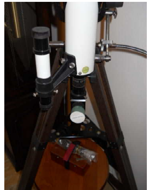
Telescopio rifrattore, montatura Equatoriale tipo Fraunhofer "SkyMaster" 76/910 - Japan anni 70 - Proprietà dell'Autore.
