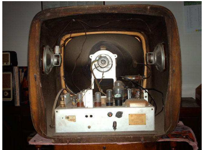
Interno tv G 1012 visto da dietro in evidenza il grosso telaio cinescopio e altoparlanti
