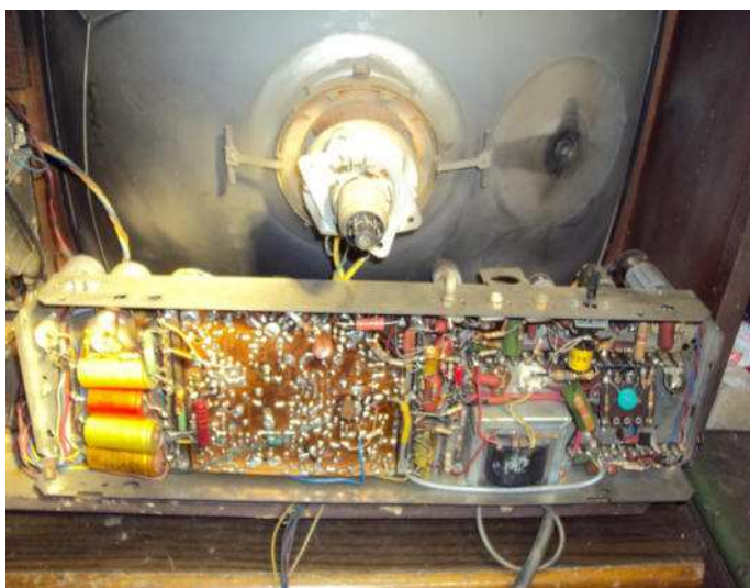
Telaio della serie tre garanzie nuvistor transistor valvole - Telaio serie 8 F... visto lato saldature
